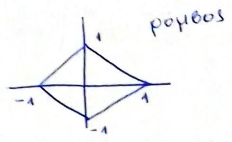
$\ell_1$  νόρμα:  $\|v\|_1 = |v_1| + |v_2| = 1$
