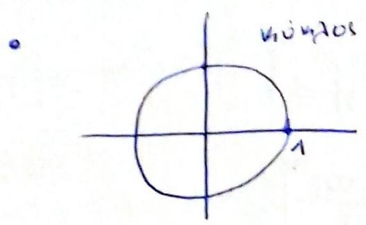
$\ell_2$  νόρμα:  $\|v\|_2 = \sqrt{v_1^2 + v_2^2} = 1$
